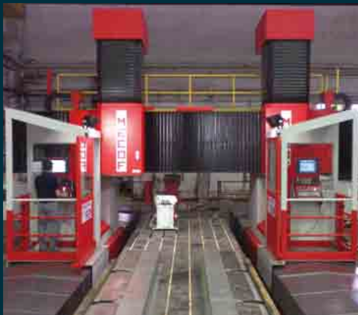
Станок в конфигурации для обработки рельсов
