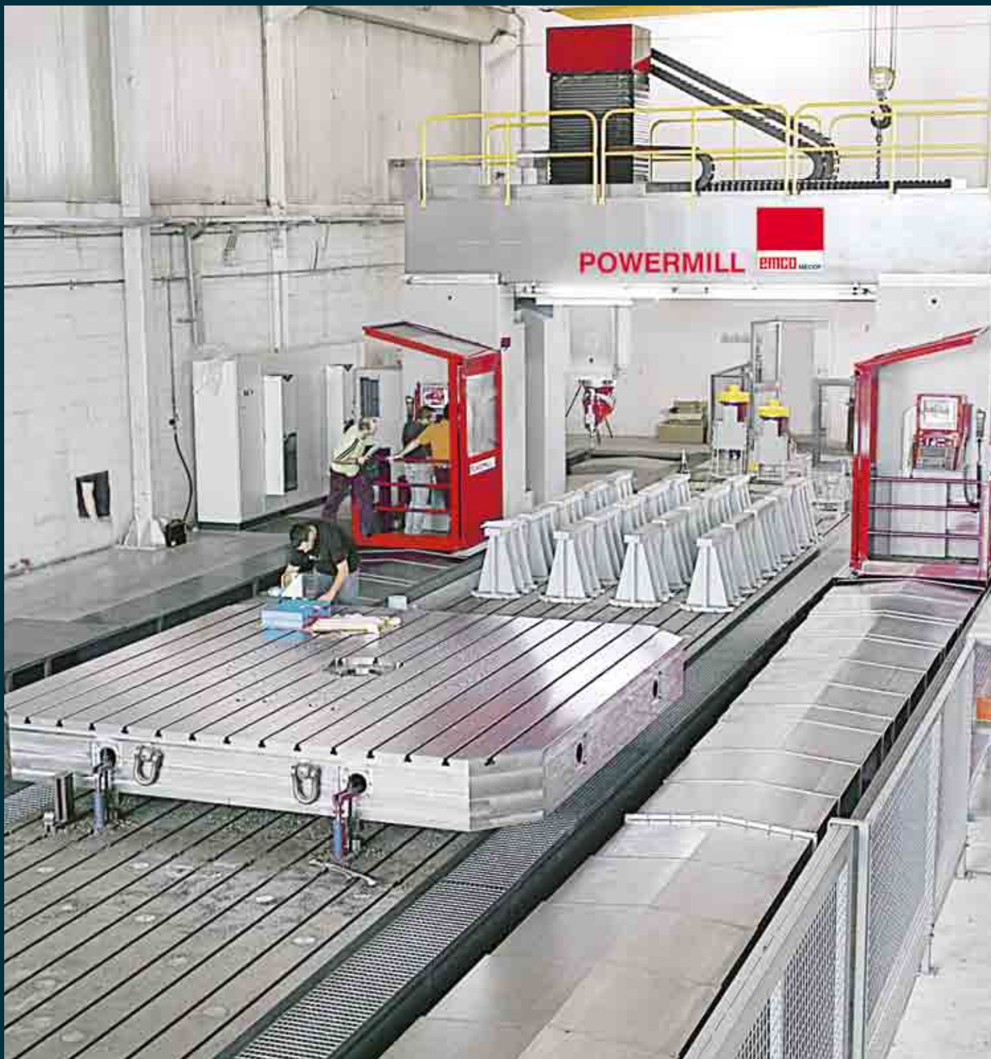
Финишная обработка поверхности поворотного стола
