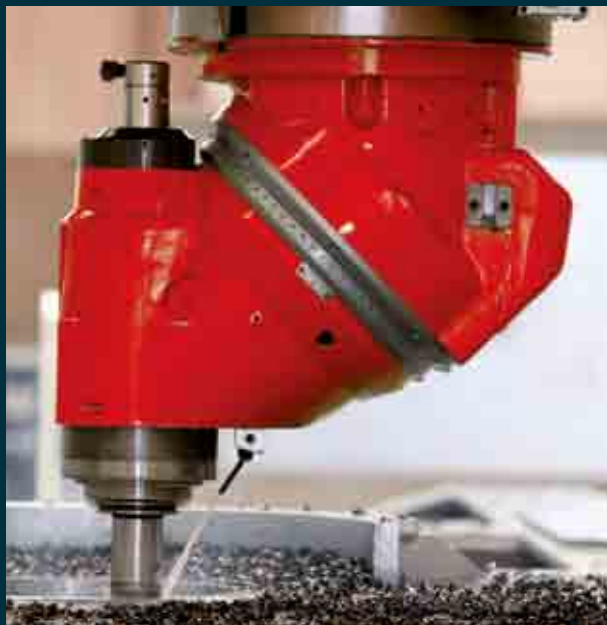
Универсальная бесступенчатая фрезерная головка с воздушно-масляной смазкой и водяным охлаждением
