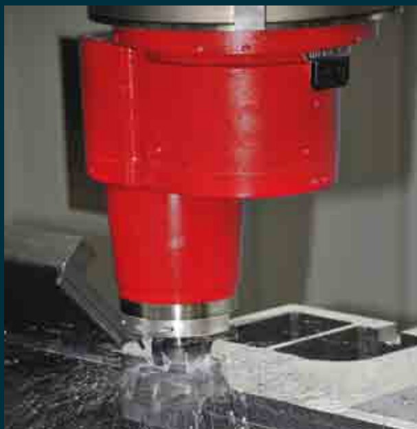
Фрезерная головка с эксцентрическим шпинделем
