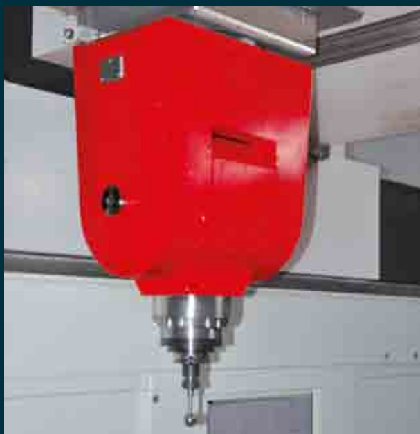
5-ти осевая вилочная фрезерная головка со встроенным высокоскоростным мотор-шпинделем
