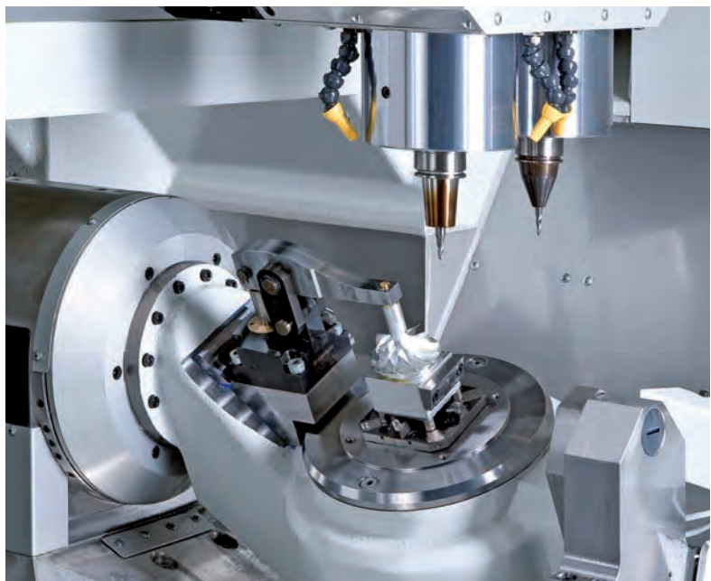
Область механической обработки RXS 500 DSI 2, установленная для обработки рабочего колеса
