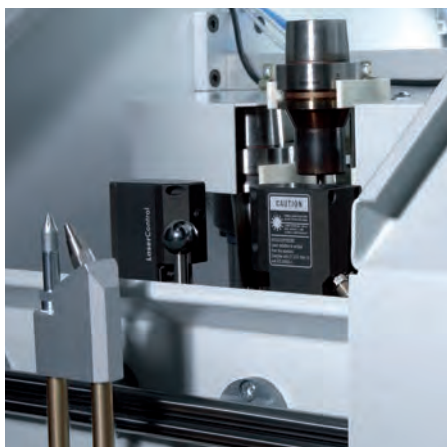
Лазерная система, встроенная в инструментальный магазин
