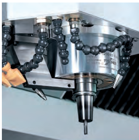
Система компенсации термического расширения шпинделя
