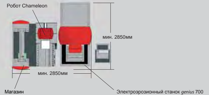
Вариант 04 (минимальная площадь пола 2850мм x 2850мм)
